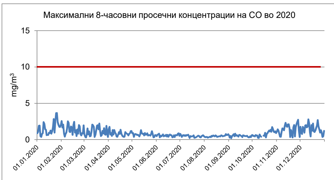
График 42: Максимални дневни 8-часовни просечни концентрации на CO во Велес во 2020 година
